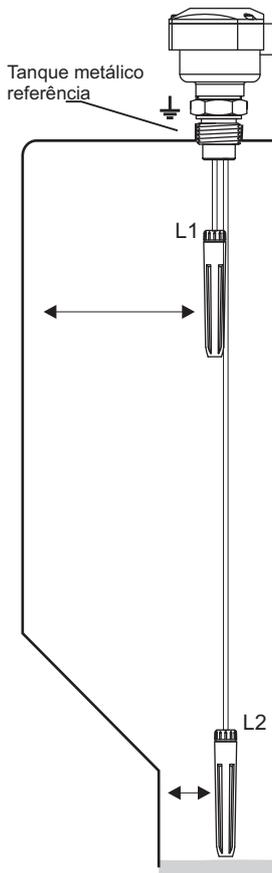
Controle de nível min e máx. utilizando elétrodo de referência.
