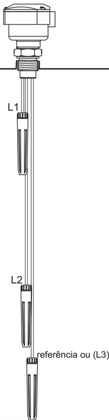
Detecção de nível de até 6 pontos utilizando o tanque metálico como referência.
