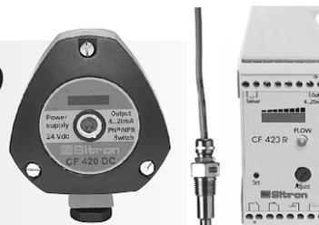
O modelo CF420 é um transmissor ideal para monitorar e controlar o fluxo de líquidos. Fornece um sinal analógico de 4...20mA e uma saída PNP. Esta tecnologia geralmente é ideal quando o usuário necessita da taxa de fluxo aproximada, mas não deseja investir na tecnologia mais cara dos medidores de vazão.
